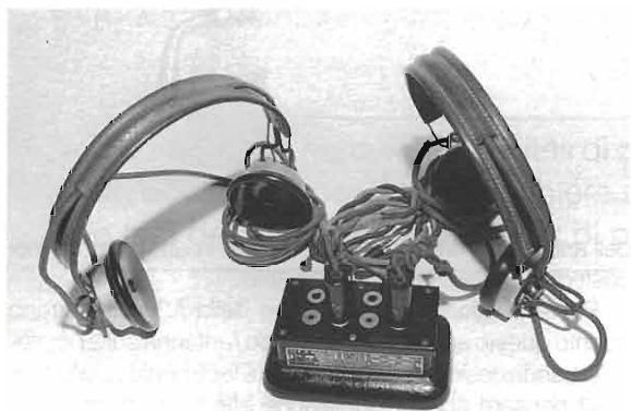
Foto 8 - Il distributore con inserite due cuffie originali Marconi.
