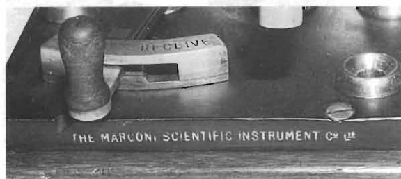
Foto 4 - Particolare della scritta e del deviatore Rx-Tx.
