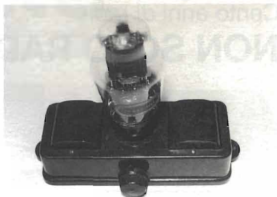
Foto 5 - Amplificatore BF ad una valvola.
